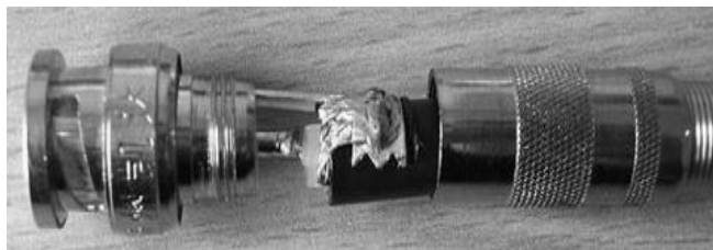
图 2.4.3 视频线缆与 BNC 头连接步骤
