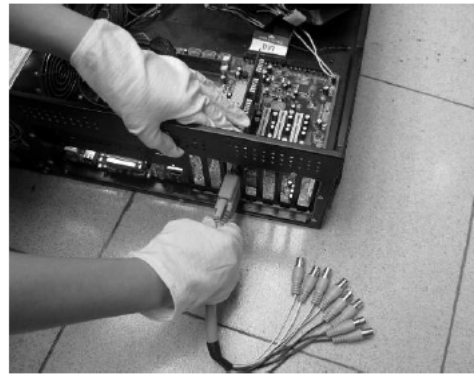
图 2.4.6 视频线缆与采集卡的连接
