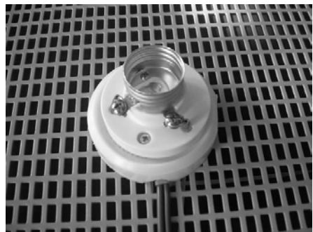
图 2.4.9 导线与平口灯座连接
