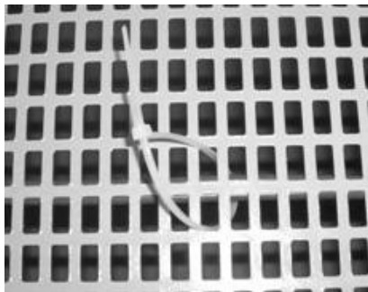
图 2.4.8 尼龙扎带绑扎导线
