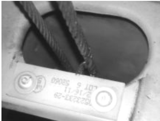
图 1.5.5 Cessna 172R 飞机副翼钢索与 WS71.125 处防磨块相磨
