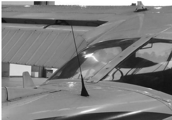
图 1.3.1 Cessna 172R 飞机鞭状 ELT 天线
