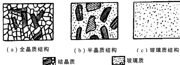
图 1.3 岩浆岩的结构示意图
