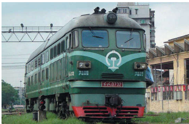
1974年东风 4 型内燃机车，最大运行速度120 km/h
