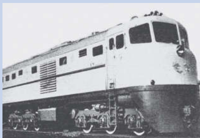
戚墅堰机车车辆厂试制成功“先行号”电传动内燃机车
