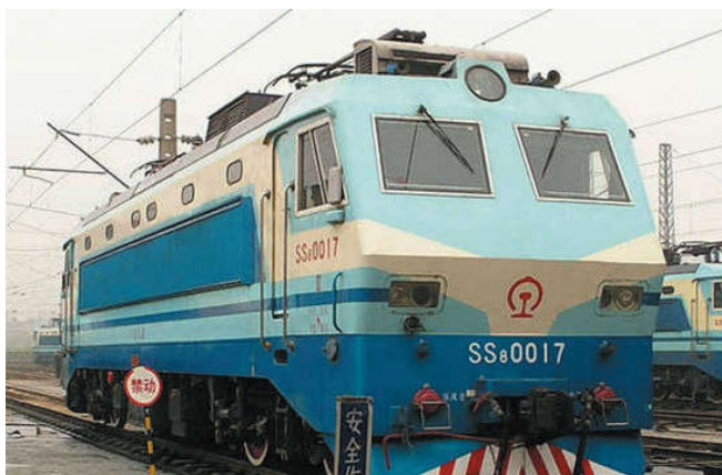
1994 年韶山 8 (SS 8 ) 型电力机车，最大运行速度 170 km/h
