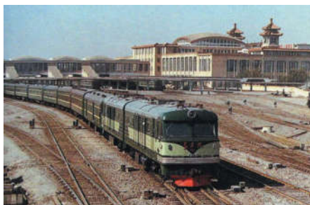
1964 年“东方红”1 型内燃机车，最大运行速度 120 km/h
