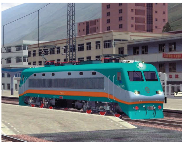
1998 年韶山 9 (SS 9 ) 型电力机车，最大运行速度 170 km/h
