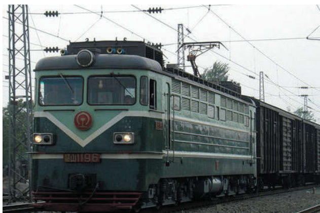
1969年韶山 1 型电力机车，最大运行速度90 km/h
