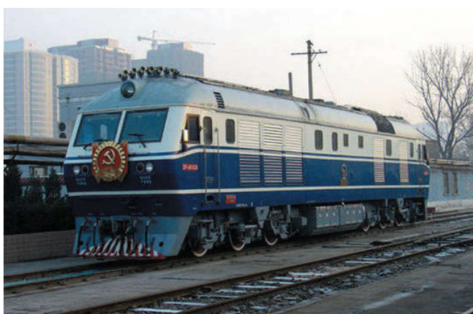
1992年东风 11 型准高速内燃机车，最大运行速度170 km/h
