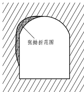
图 2-4 倾斜岩层隧道边墙和拱部的张拗折坍落造成的塌方
