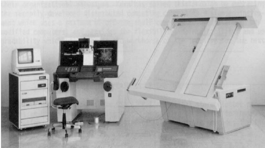
图 1.3 瑞士 Kern 厂 DSR-1 型解析测图仪
