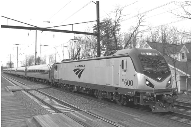
图 1.3 美国铁路ACS-64 型电力机车<sup>①</sup>
