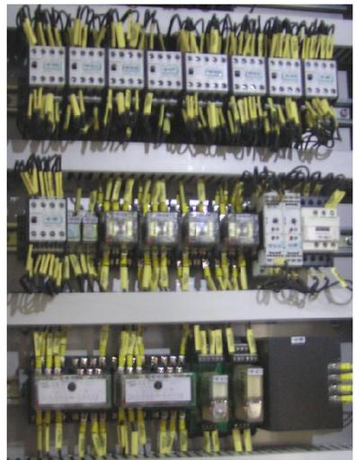
图 4.1 地铁车辆电气设备柜中的继电器
