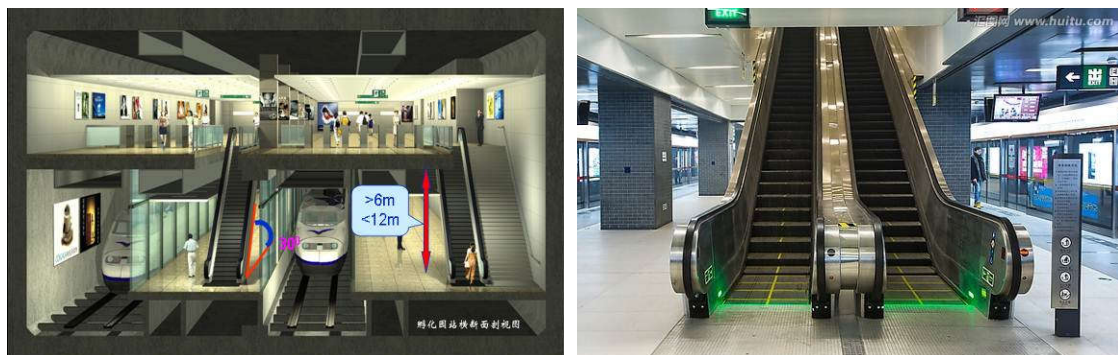
图 2.2.15 地铁车站楼梯、自动扶梯的布置
