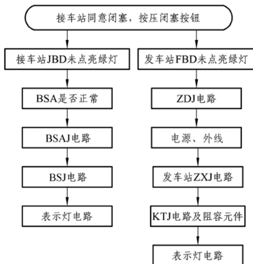
图 1.7.2 接车站同意接车后动作程序图
