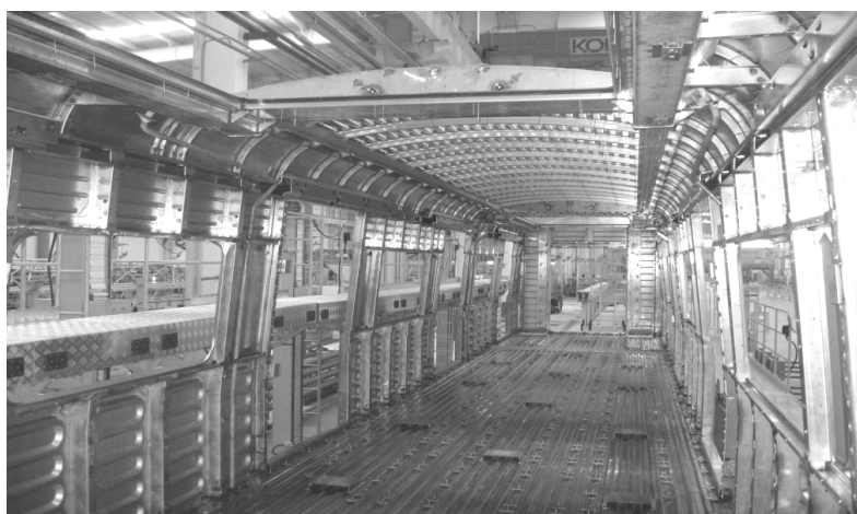
图 1-2 焊接组装成的车体钢结构
