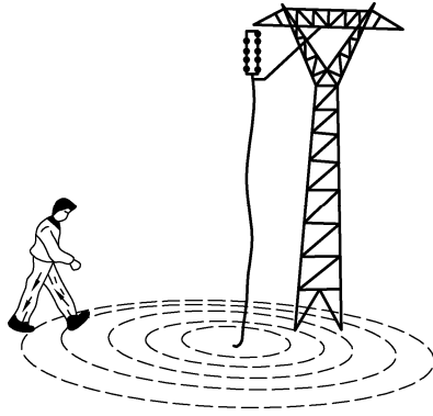
图 1.1.3 跨步电压触电
