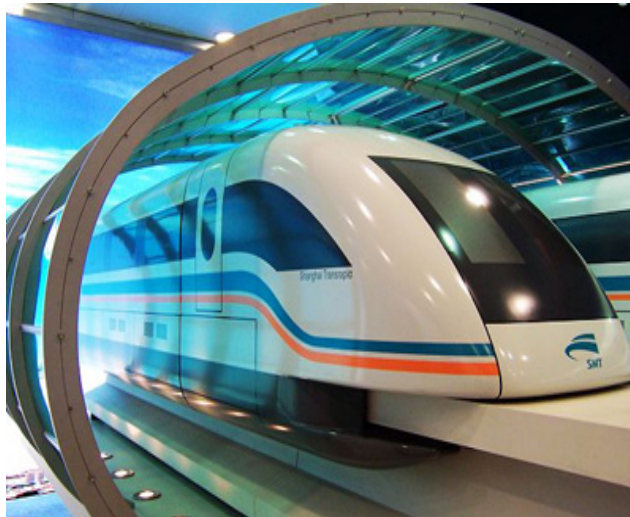
图 1-7 高速磁悬浮列车
