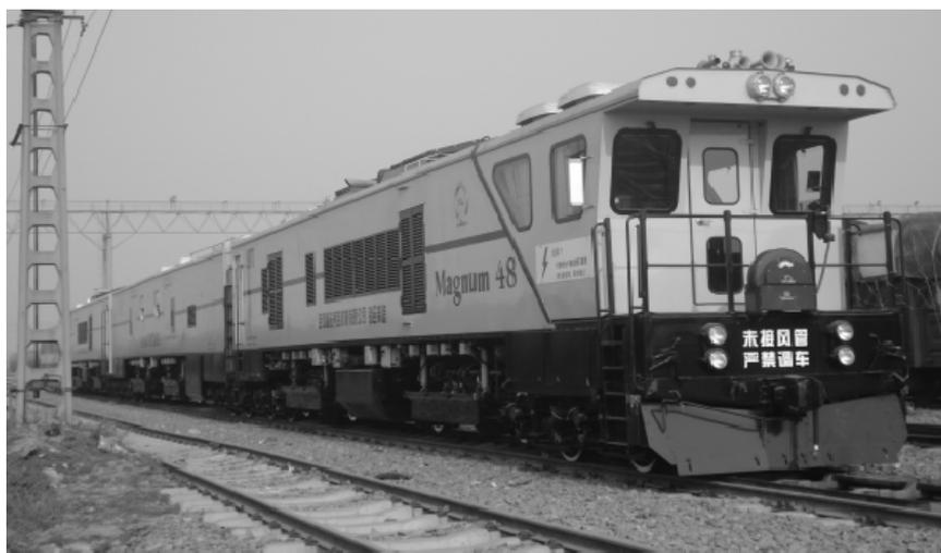
图 1-7 PGM-48 型钢轨打磨列车外形结构
