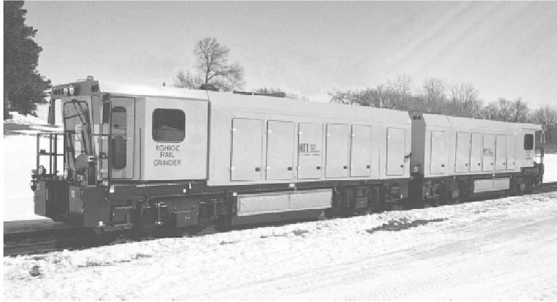
图 1-2 RGH20C 型道岔打磨列车
