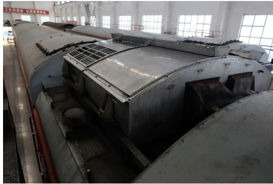
图 1-2 客车空调机组在车辆上的安装位置
