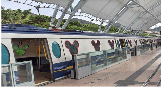
图 1-1-4 香港地铁迪士尼线半高半封闭型安全门
