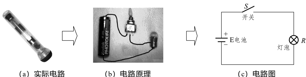
图 1-2 实际电路与电路图的关系
