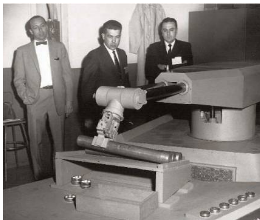
图 1.1 第一台机器人 Unimate
