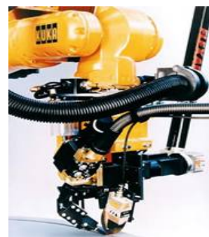
第三代工业机器人：即智能机器人或自治机器 图 1.3 配备视觉系统的工业机器人
