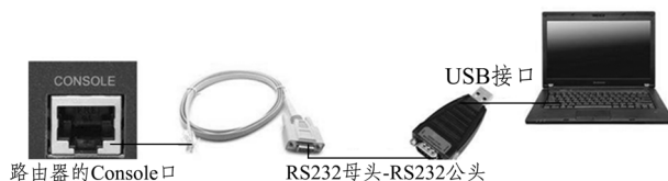
图 1-12 借助 USB 转串口连接器进行 Console 连接
