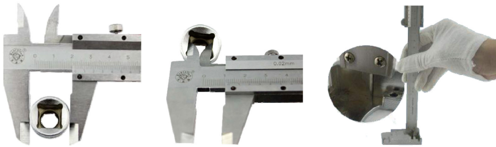
图 1-7 用游标卡尺测量工件
