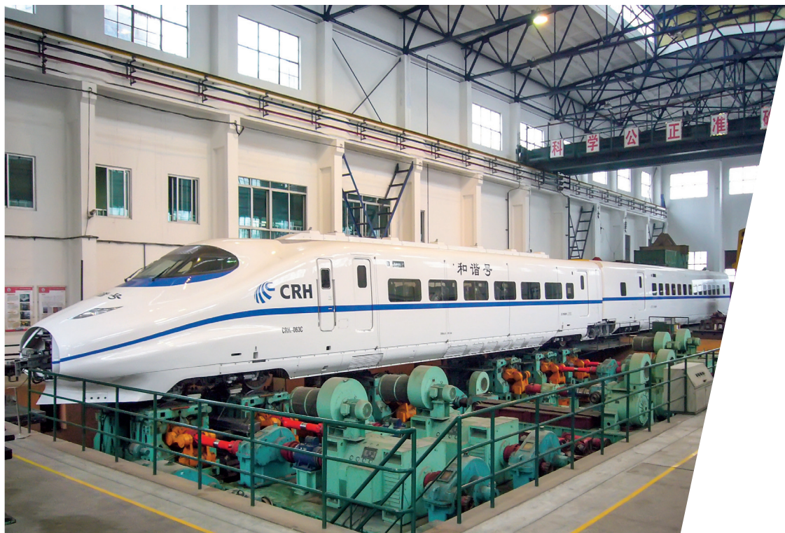
CRH2-300在试验台上试验到410千米时速
