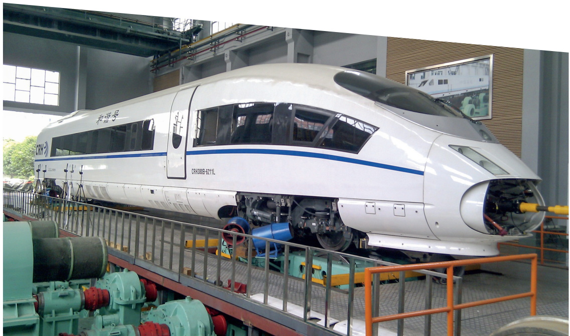
CRH380B在试验台上试验
