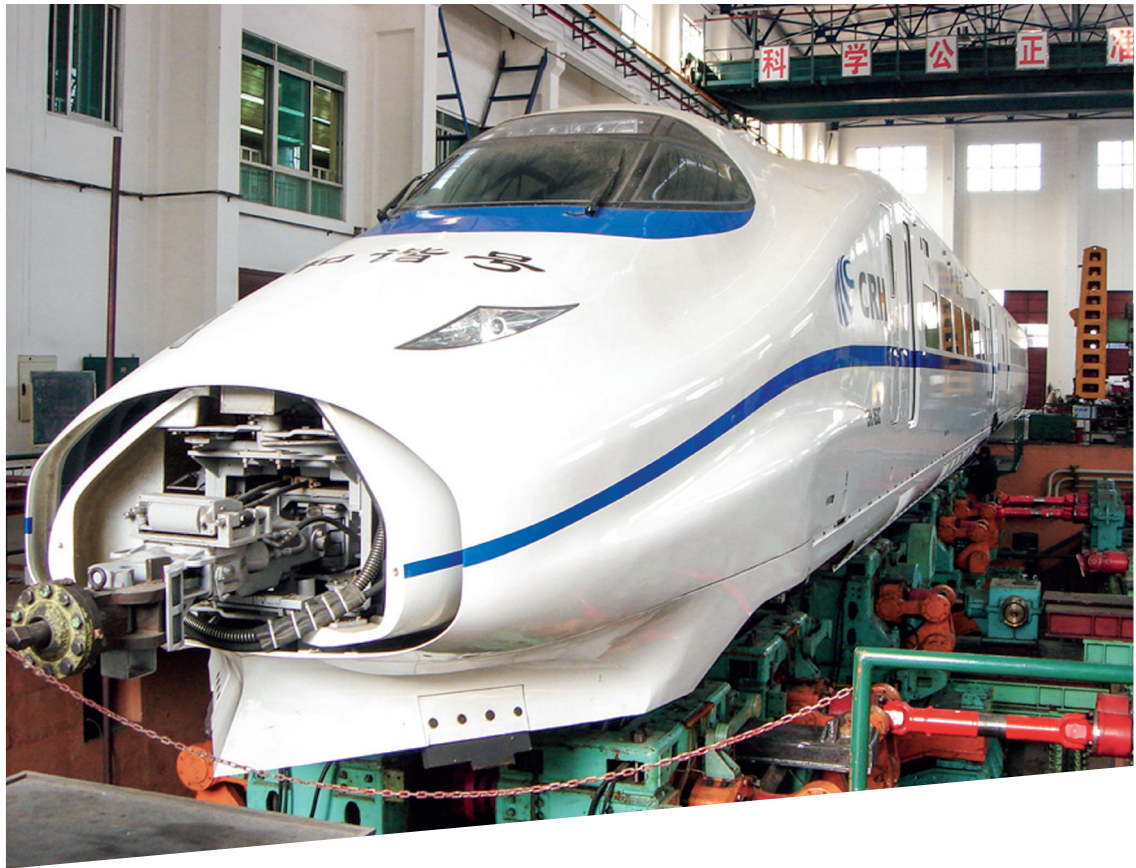
CRH380B在试验台上试验
