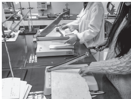
图 1.7 测试抗张强度纸张取样
