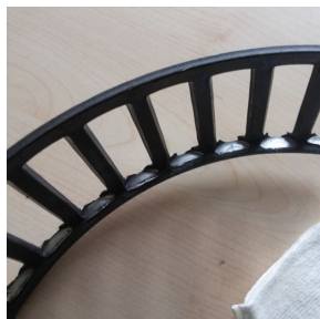
A 型齿轮箱轴承保持架偏磨
