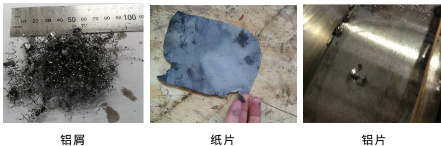
图 1-3 B 型齿轮箱内部异物
