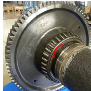
B 型齿轮箱轴承内圈与车轴打滑
