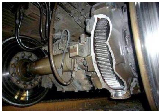
图 1-8 日本新干线某高速列车齿轮箱开裂故障
