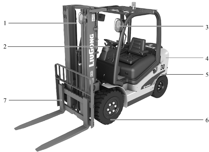
图 1-1-4 3 吨内燃叉车整机构造图
