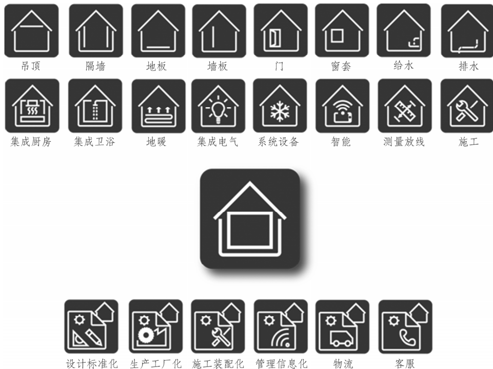
图 1-16 装配式建筑装饰模块化拆解
