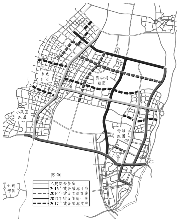
图 1-3 保山中心城市地下综合管廊区位图
