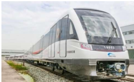
图 1-1-23 成都地铁 18 号线（最高运行速度 140 km/h）
