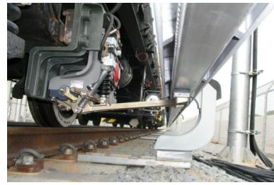
图 1-1-9 车底接触器与接触轨（侧式）侧面
