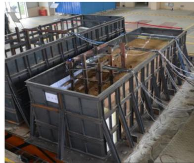
图 1-4 某高陡边坡地震安全性评价振动台试验
