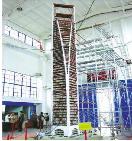
图 1-3 上海环球金融中心振动台试验
