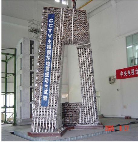
图 1-2 CCTV 主楼振动台试验
