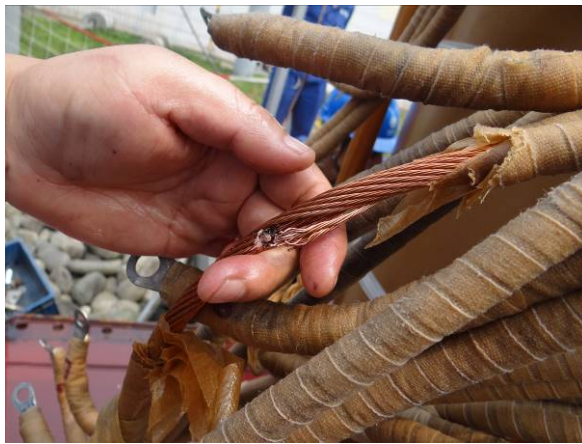
图 1-16 分接开关引线断股部位
