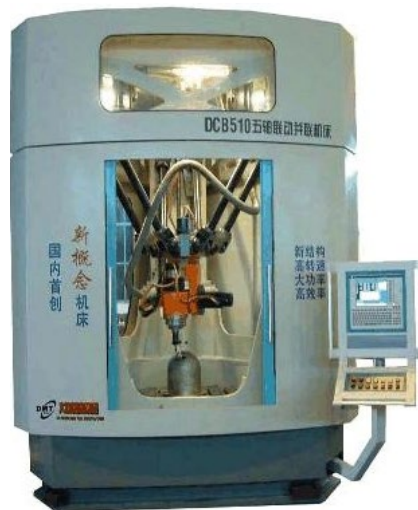
图 1-8 我国自主研发的并联机床
