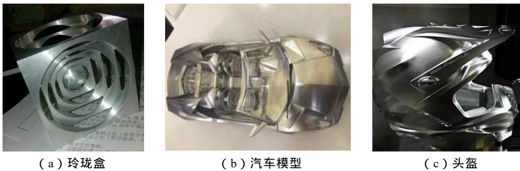
图 1-4 数控机床加工的复杂形状零件
