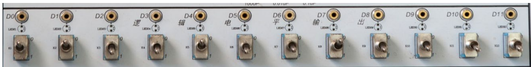
图 2.1.19 逻辑电平输出区
