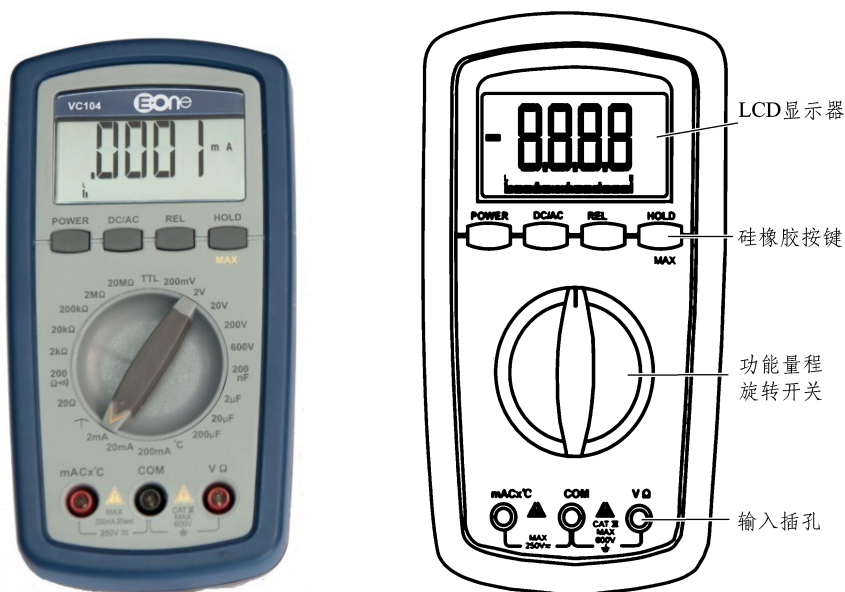
图 2.1.2 EONE VC104 型数字万用表示意图
