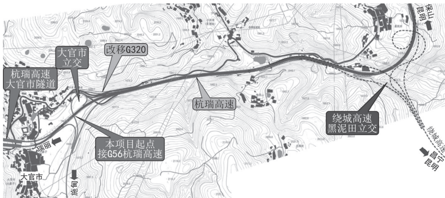
图 2-2 起点接线方案图
