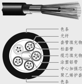
图 1.10 光缆结构图
