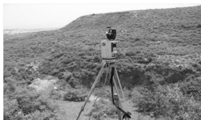
图 1-1-4 地面航空摄影测量——激光扫描仪
