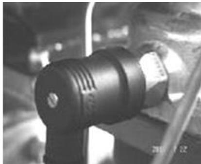
图 2.27 压力开关
