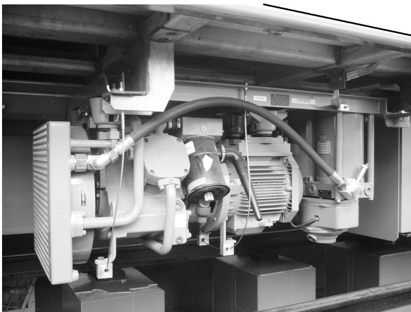
图 2.2 供风系统在车辆上的安装位置
