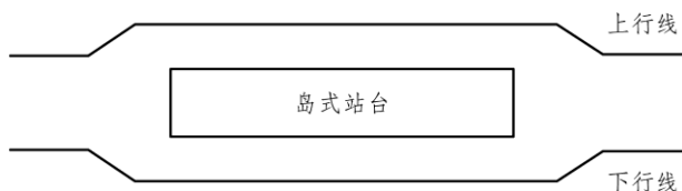
图 1-5 岛式站台车站示意图
