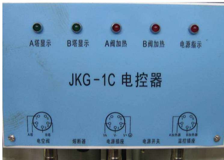
图 2-4-4 JKG-1C 型空气干燥器工作指示图
