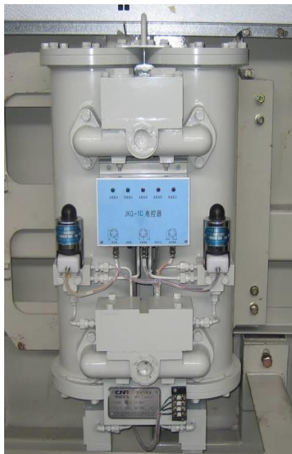
图 2-4-2 JKG-1C 型空气干燥器外形图
