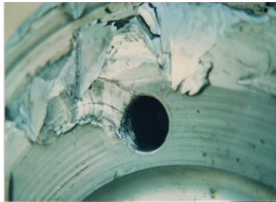
(f) 铝裙螺栓孔内螺纹
