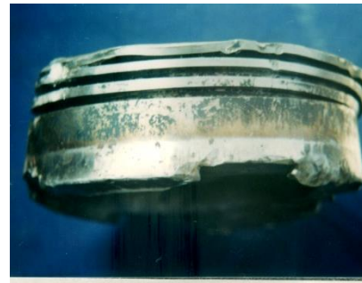
(i) 钢顶一侧的边缘受摩擦留下痕迹
