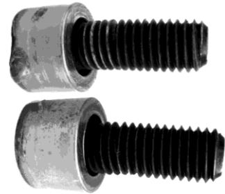
图 1-7 将断裂成两段的两颗螺栓断口复原的螺栓形状照片（测定断裂位置基本相同）
