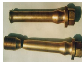
(a) 断裂的 4 颗活塞下穿螺栓 (b) DJ96093888 活塞下穿螺栓断口 (c) 断裂的连杆螺栓
