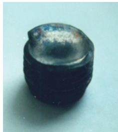
(a) 断裂的 4 颗活塞下穿螺栓 (b) DJ96093888 活塞下穿螺栓断口 (c) 断裂的连杆螺栓
