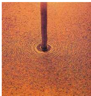
图 1.2.4 通电导线周围的磁感线
