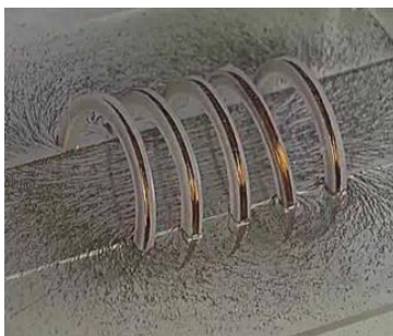
图 1.2.8 通电螺线管周围的磁场
