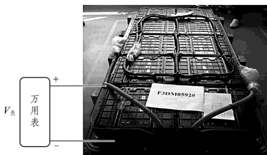
图 1-26 测量电池包高压 V_{\text{负}} 对壳体电压
