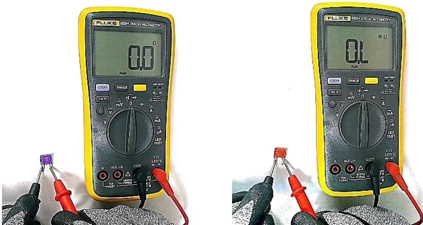
图 1-8 测量熔断器电阻
