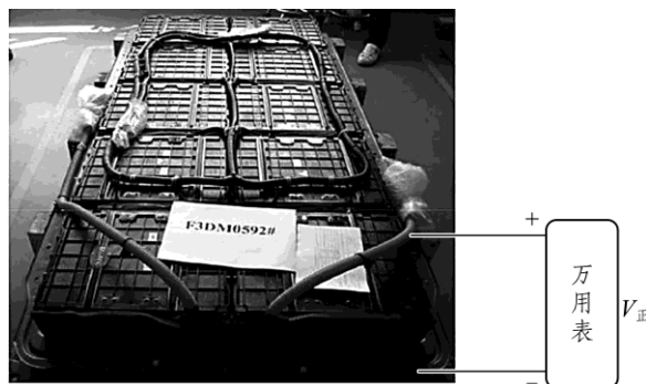
图 1-25 测量电池包高压 V_{正} 对壳体电压
