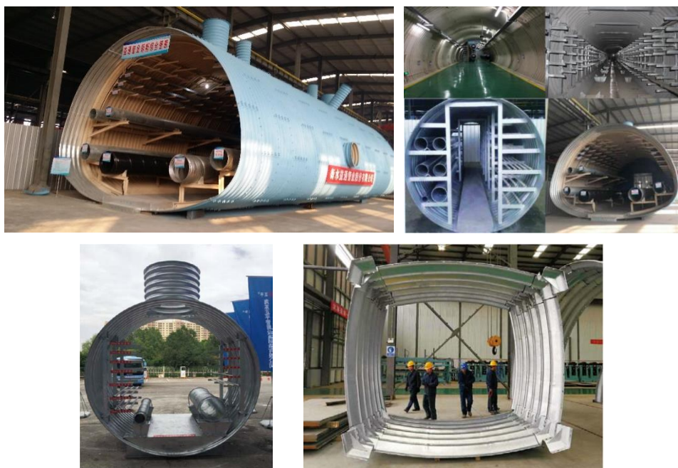
图 1.29 钢波纹板地下综合管廊案例
