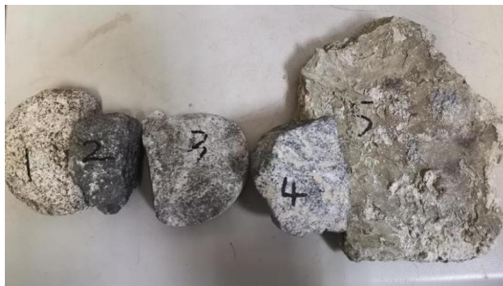
1—中风化混合花岗岩；2—中风化黑云变粒岩；3—中风化花岗片麻岩； 4—中风化花岗片麻岩；5—强风化糜棱岩。
