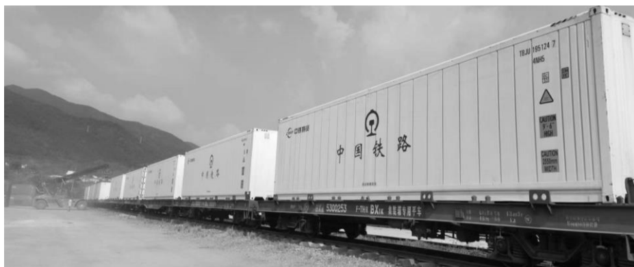
图 1-5 “1 个发电箱供电 + 8 个冷藏箱” 车组
