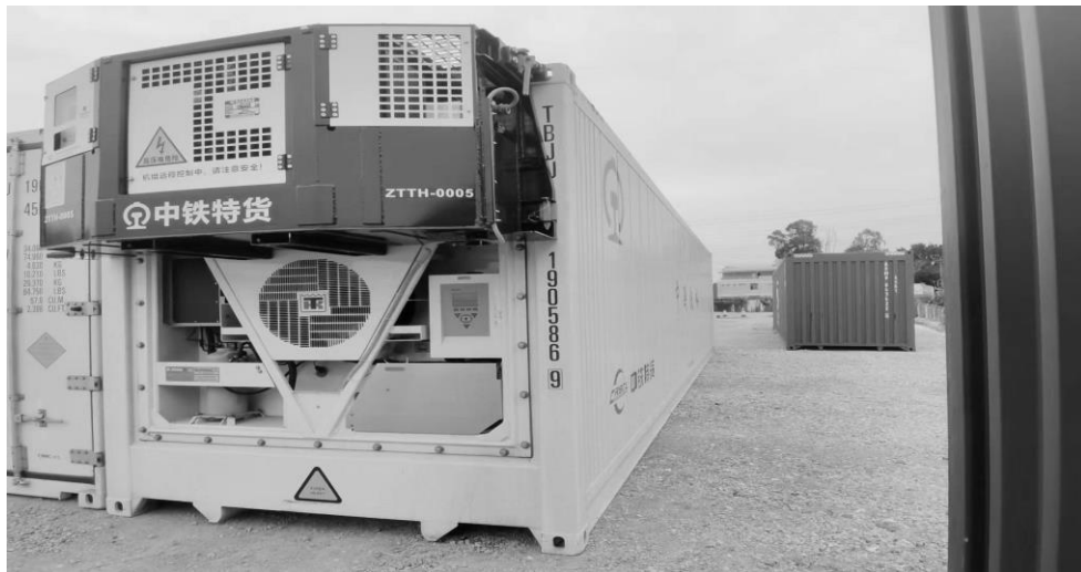
图 1-7 外挂式柴油发电机组冷藏集装箱
