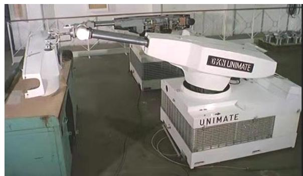
图 1-10 乔治·戴沃尔的机器人 Unimate
