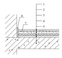
1一饰面层;2一保护层;3一弹性垫层或隔声保温垫层;4一找平层;5一钢筋混凝土楼板结构层; 6一竖向隔声片;7一钢丝网片(细石混凝土保护层时需要)。
