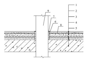
1一饰面层; 2一保护层; 3—弹性垫层或隔声保温垫层; 4—找平层; 5—钢筋混凝土楼板结构层; 6—竖向隔声片; 7—建筑密封胶; 8—钢丝网片; 9—穿楼板竖向管道及套管。
