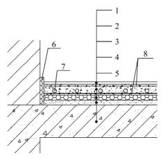
1一饰面层; 2一保护层; 3—弹性垫层或隔声保温垫层; 4—找平层; 5一钢筋混凝土楼板结构层; 6一竖向隔声片; 7一加热管; 8一钢丝网片。
