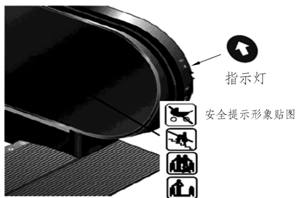
图 1-4-3 运行方向指示灯及安全提示
