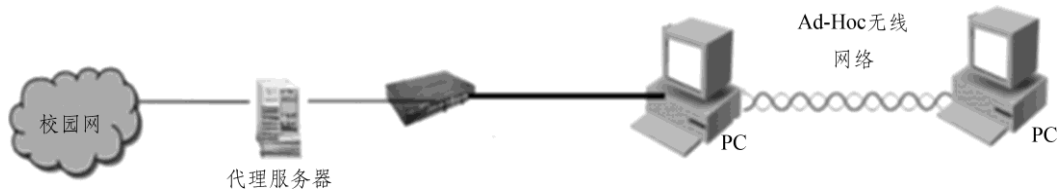
图 1-4 Ad-Hoc 对等无线网络接入 Internet 实验拓扑
