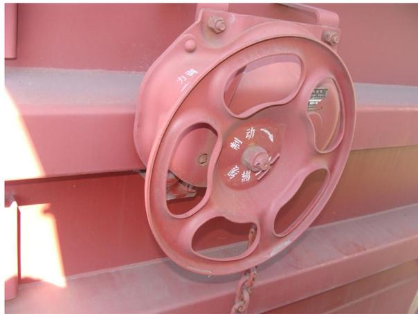
图 1-2 货车人力制动机
